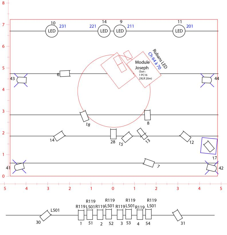
Notes : sur le module de Joseph se trouve également 2 ruban LED et leurs 2 boîtiers en DMX3pts. les boîtiers ont un Out et un In, ils peuvent être dans un élément dans la boucle du réseau DMX
